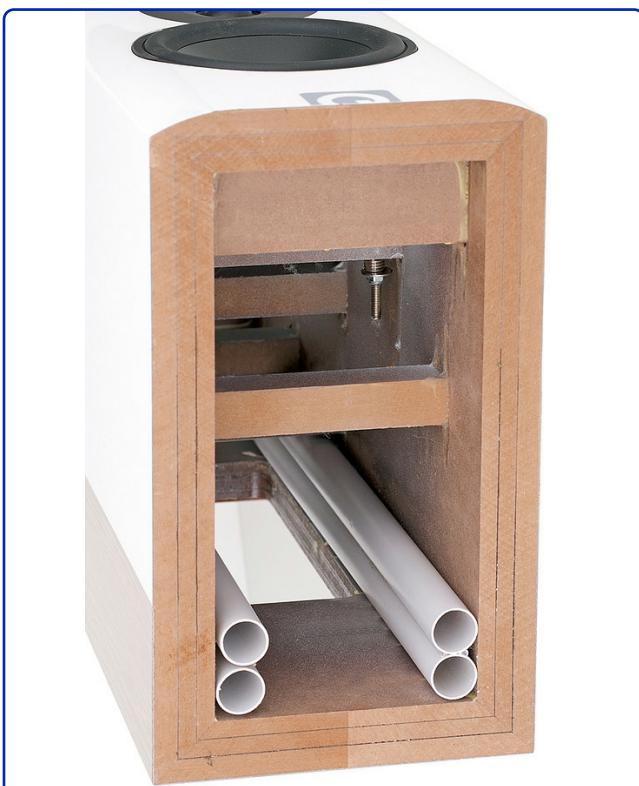
***Nach Entfernen des Deckels kann man die dreilagige MDF-Gehäusestruktur gut erkennen. In den Zwischenräumen befindet sich ein nicht trocknendes Gel, das Schwingungsenergie aufnimmt und in Wärme verwandelt.***
